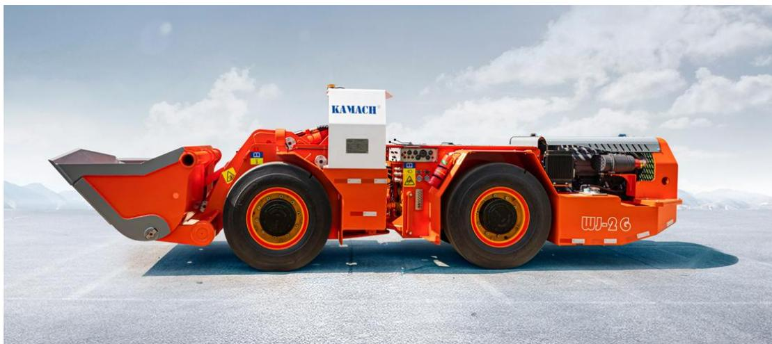
WJ-2G 地下轮式铲运机 | Scooptram 是一款中央铰接式车架地下轮式铲运机，配备 S 形自平衡结构动臂，驾驶室位于底盘后部，配备 FOPs+ROPs 开放式驾驶室。采用瑞典耐磨铲刀和侧铲。前桥采用 NO-SPIN 防锈设计；
